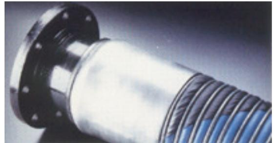
La manguera que ofrecemos para estos productos es nuestra BIOFLEX V-AG y V-IG, disponible en 1/2" a 4" de diámetro, con una presión de trabajo máxima de 5, 10 y 14 Kg. /m<sup>2</sup>. Esta manguera, con su tubo interior de material especial, posee una excelente resistencia al biodiesel y a los alcoholes.
